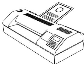
連続してラミネートする時は、必ず前にラミネートしたものをフィルム取出口から取り出した後で、次のパウチフィルムをフィルム挿入口に入れてください。
